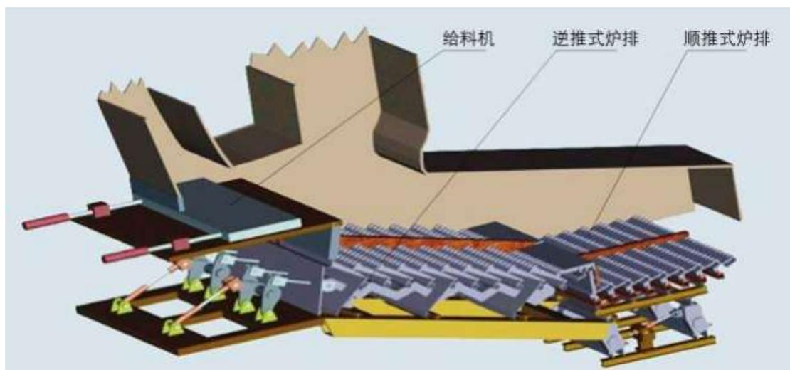
公司的二段往复式多列生活垃圾焚烧炉由逆推炉排和顺推炉排组合而成。逆推炉排向下倾斜，而顺推炉排为水平布置。垃圾由给料机推入床面，垃圾在逆推炉排上作翻动、搅拌和破碎而达到充分的燃烧，基本燃尽的垃圾经过一段落差进入顺推炉排继续翻动燃烧，直至垃圾中可燃物燃尽而排出炉体。
